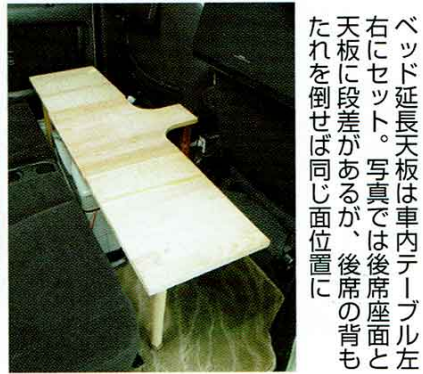
ラゲッジにセットした収納兼ベッド天板は、軽く仕上げるため18mm厚の桐材を利用。強度的にも十分という
