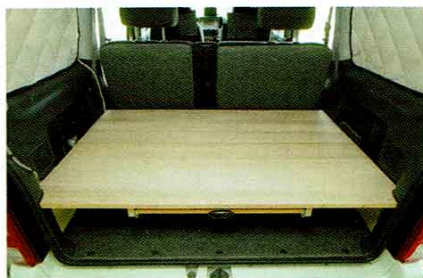
ラゲッジにセットした収納兼ベッド天板は、軽く仕上げるため18mm厚の桐材を利用。強度的にも十分という
