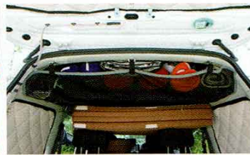
天井に備え付けた棚はアルミアンクルをボディに固定し、ここに突っ張り棒を5本渡して棚として使っている
