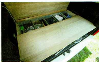
天板は2分割式にすることで、荷物を取り出しやすくした。ここにはルーフトent用のハシゴやキャンプ用品を主に収納する
