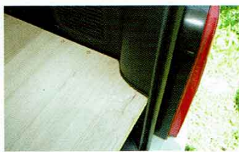
天板は内装のアルに合わせてフィッティング。千葉さんは大まかな図面を書き、ホームセンターの切断サービスを利用する
