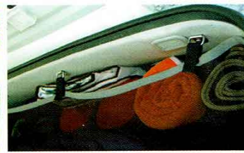
天井棚に収納した荷物が走行中に落ちないように、家庭の玄関用網戸の生地を加工し、D環を介してビスで装着している
