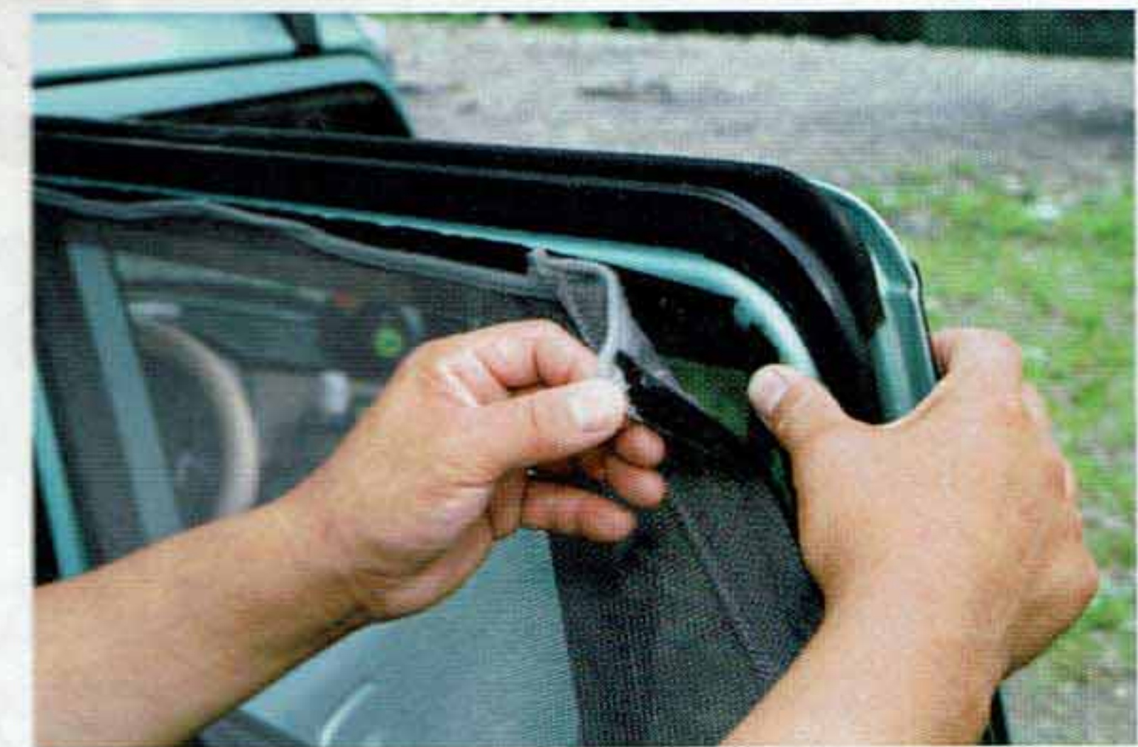
佐藤さんがクルマの防虫ネット用に使っているのは、玄関用の汎用アミ戸。生地がソフトで折り目がつかず、またカットしても切断部がほつれにくいので加工しやすいとのこと
