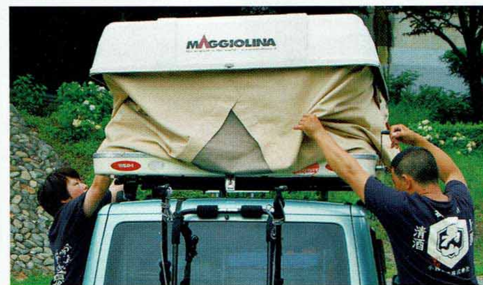
佐藤さんがクルマの防虫ネット用に使っているのは、玄関用の汎用アミ戸。生地がソフトで折り目がつかず、またカットしても切断部がほつれにくいので加工しやすいとのこと
