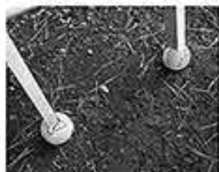
●ハンゴの脚の先端はプラスチック製。滑りとズレの防止のためにゴムボールを切ったものを取り付けた
