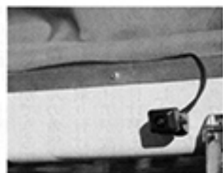
●バックモニターカメラはテントの下側に取り付けて、配線はフレームの縁を使って前面に隠している
